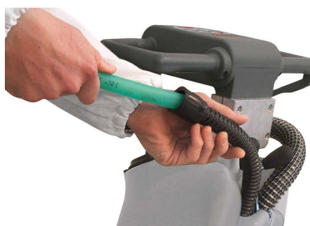
Vispa 35 B-BS Pulizia periodica del tubo tergilavaggio per garantire un'efficiente aspirazione
