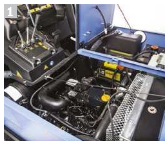
1 Motore Yanmar 3 cyl raffreddato ad acqua.
