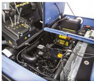
1 Motore Yanmar 3 cyl raffreddato ad acqua.
