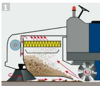
1 Carico dello sporco. Sistema di carico dello sporco anteriore.
